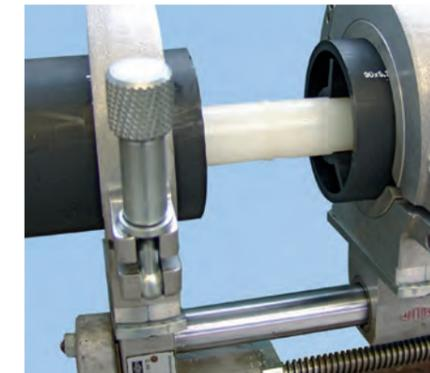
Kaskadenschweißung – Die Kaskadenschweißung kann für Doppelrohrsysteme in allen Materialkombinationen eingesetzt werden.
