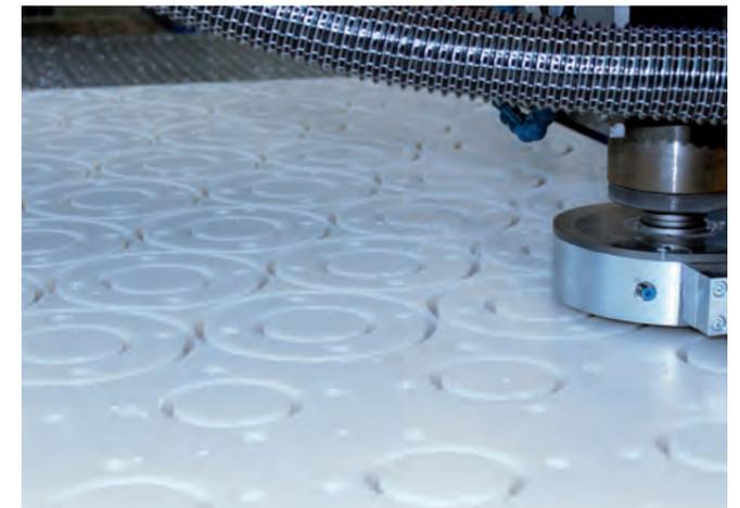
Platten in der Weiterverarbeitung – Fertigung von Flanschen aus ECTFE für den Einsatz von hochaggressiven Medien.
