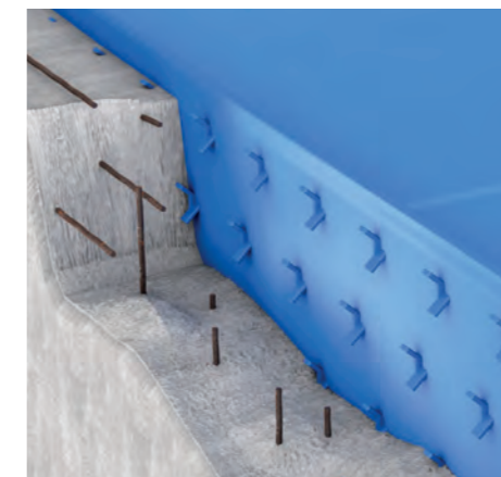
Das Hydro+-System wird direkt auf die Schalung aufgebracht und im Anschluss mit dem Beton vergossen.
