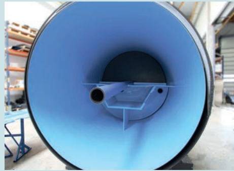
Quellsammelschacht im Bau mit 2 Zulaufkammern
