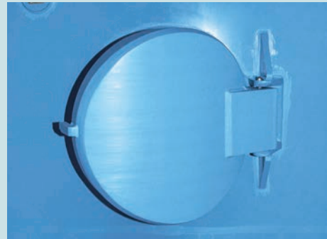
PE-Drucktür aus der Wasserkammerperspektive
